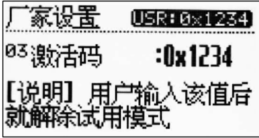
图 7: 参数设置界面 (厂家参数) 操作方式与用户参数设置相同.
